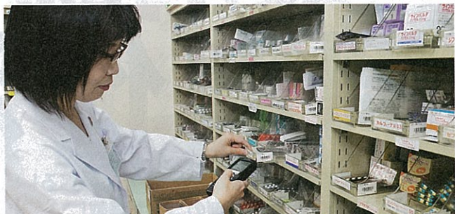
長崎中央調剤薬局では、「ミスゼロ子」のハンディ端末をピッキングで3台、鑑査で2台使用している。鑑査時にはレシートに印刷されたバーコードを読み取って確認する(下)
