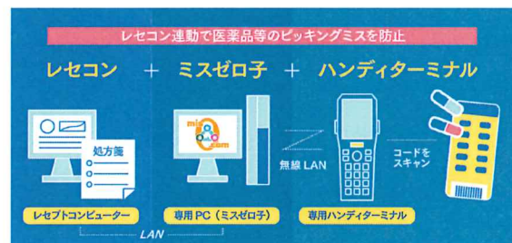
端末で薬品GS1読取り、入力処方と照合
